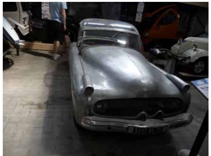
Velo Gonnet, prototype de 1952. Moteur électrique en position arrière et moteur à 2 temps à l'avant. Hybride avant l'heure !
