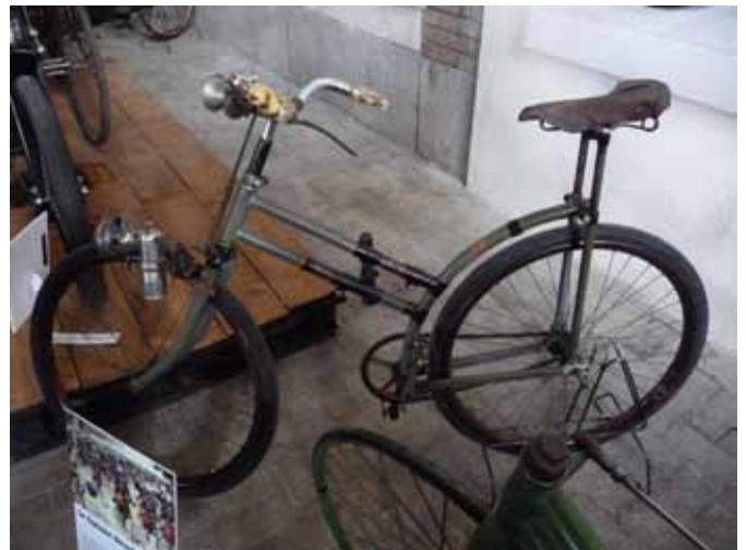
ancêtre du vélo pliant ce vélo a été inventé en 1895 par le capitaine Gérard. Pliage en moins d'une minute
