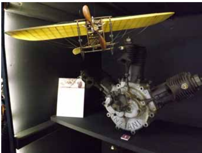
Moteur à quatre temps Anzani : 3 cylindres en W, cylindrée de 3 750 cm 3 développant 30 cv à 1 400 tr/mn
