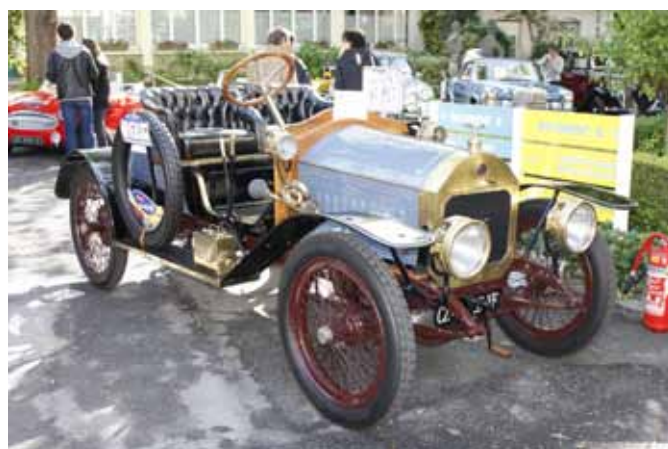
UNIC C1 de 1910 avec un moteur Ballot 1,4l - 4 cylindres borgnes - BV 4 rapports
