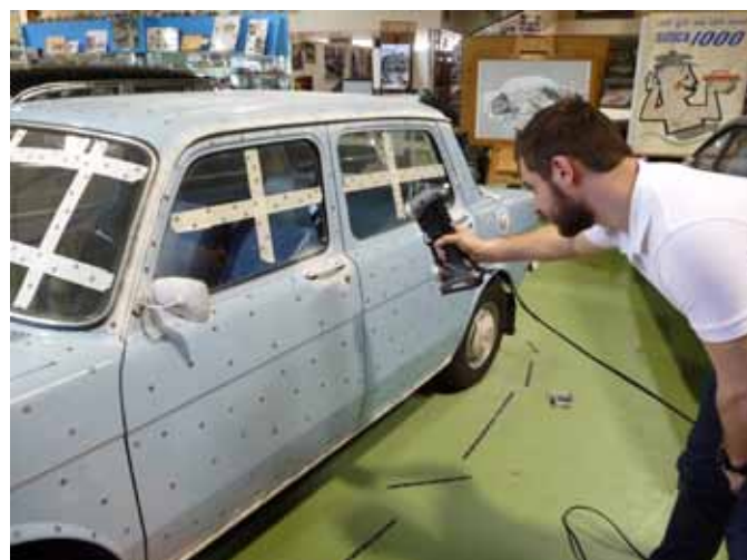
Après pose des pastilles, balayage manuel de toute la surface
