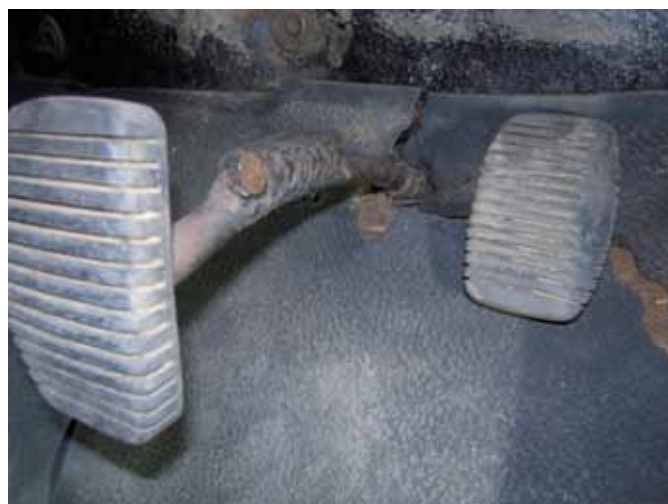
Sur la pédale d'embrayage subsiste la trace de la soudure de la tige transversale.
